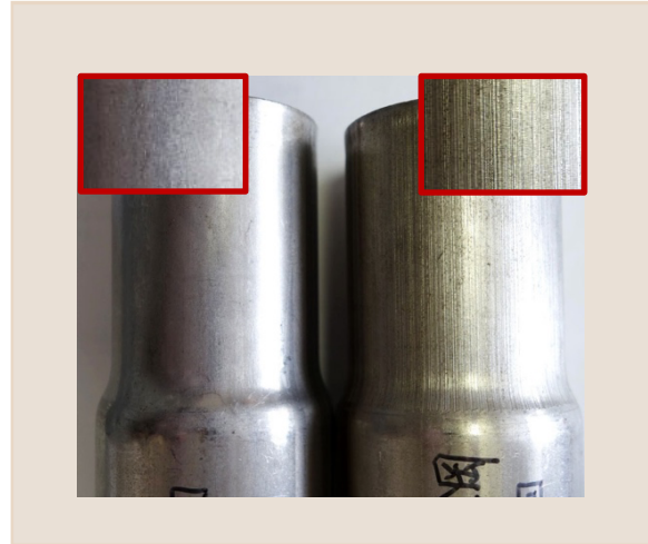
製品サンプル 左:タイアスト 右:ダイス鋼+TD 処理
